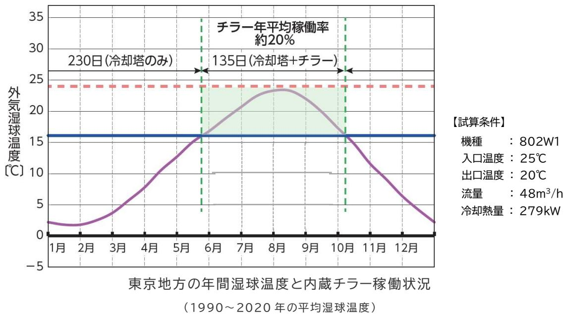
この冷水使用条件においては、冬期を含む平均 230 日間は内蔵冷却塔のみにより 20°C の冷水を供給し、それ以外の 135 日間は冷却塔とチラーのハイブリッド運転が行われます。
