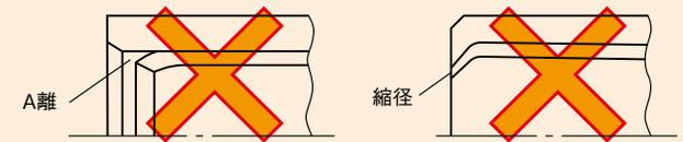
切断、面取り、ねじ切り時、上図のように管端のライニングが剥離又は、管端が縮径したものは使用しないでください。そのまま使用しますと、ライニングがめくれたり、管継手のプラスチックコアを潰したりするおそれがあります。
