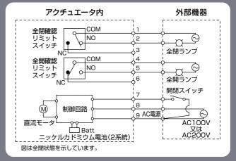
注1) 回路図に従って配線してください。(8-9間は常時通電) 開閉スイッチのNで開弁 闘関スイッチのEFで閉弁
