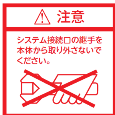
図 5-3 システム接続口アダプタ分解防止
