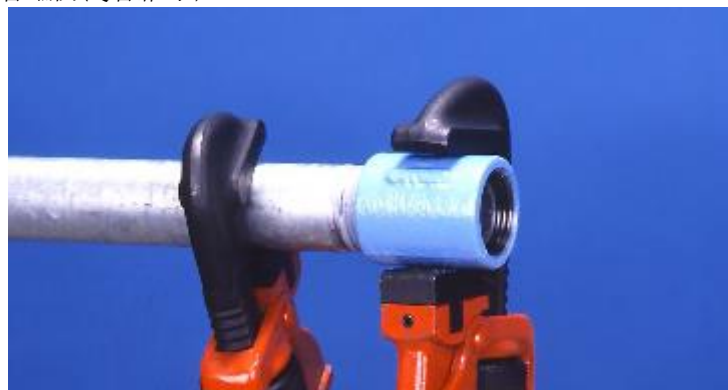
図 9 パイプレンチの使用方法
